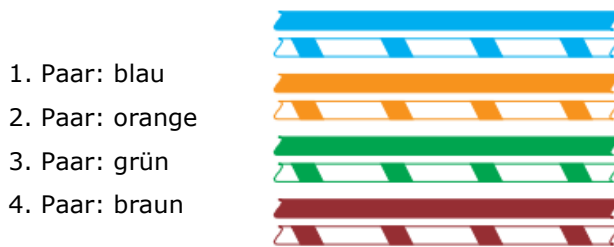
Abbildung 4: Farbcode und Zählweise eines Netzwerkkabels (EIA/TIA-568B)
